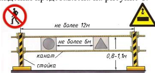
Рисунок 1 – Схемы защитного стоечного ограждения
